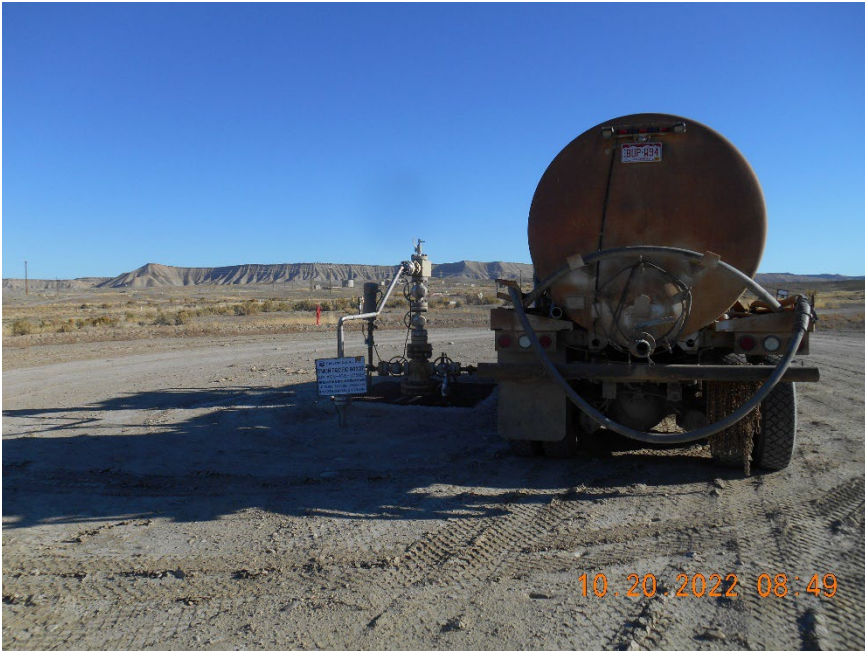
Injection wellhead during MIT
