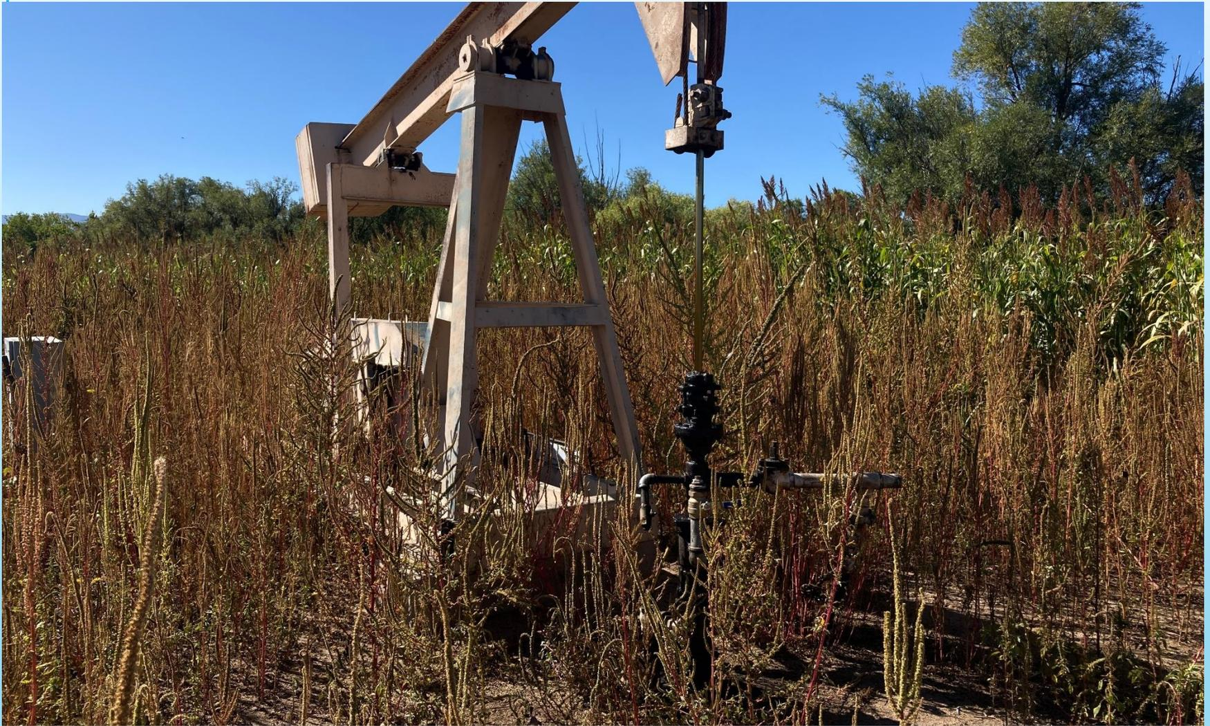
**PHOTO 1: LOCATION/WEEDS AROUND PUMPJACK NOT MAINTAINED. MAINTAIN WEEDS/VEGETATION AROUND WELLHEAD AND PUMPJACK PER RULE 606. CA DATE 11-12-2022.**
