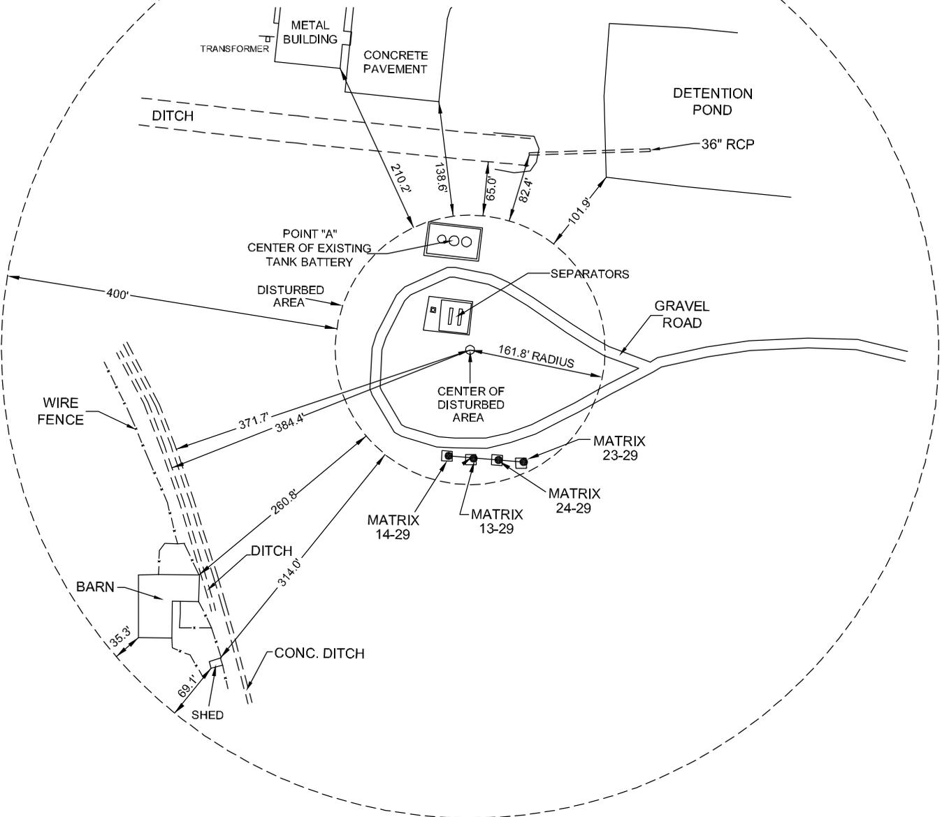
POINT "A" (CENTER OF TANK BATTERY) TO MATRIX 23-29 = 278.2'
